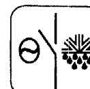
Термостат окончания оттайки
